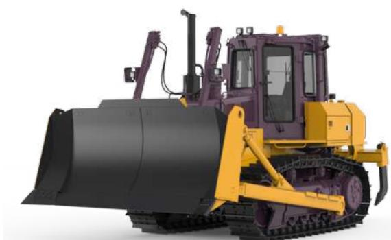
Используется в промышленном, нефтегазовом, гидротехническом и дорожном строительстве. Имеет модификации для лесного хозяйства и мелиоративных работ. Сочетает в себе маневренность, производительность и универсальность.
