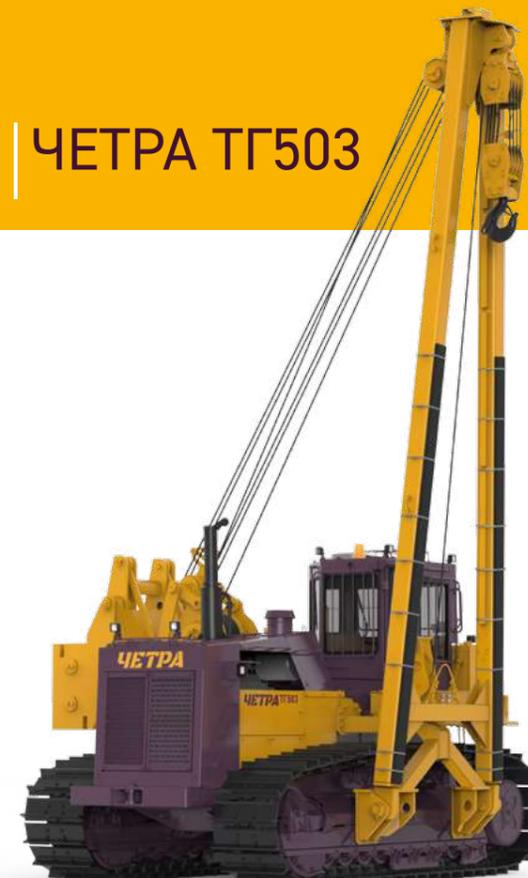
Самый массовый трубоукладчик ЧЕТРА для укладки трубопроводов в траншею, сопровождения очистных и изоляционных машин, для подъема и перемещения единичных грузов.
